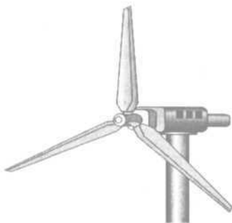
Рис. 11.9. Ветроэнергетическая система с горизонтальной осью вращения двигателя
