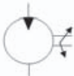
Pompe hydraulique à cylindrée fixe à un sens de flux et un sens de rotation
