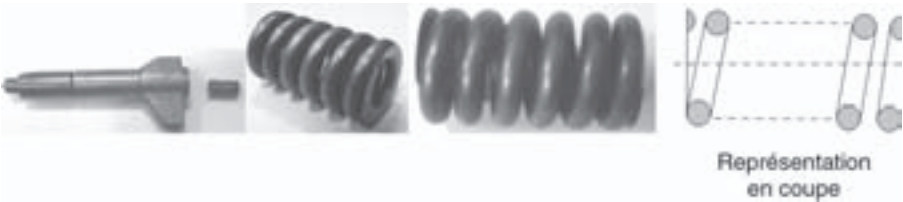
Figure 19.14 – Ressort de compression d'un injecteur diesel de bateau.
