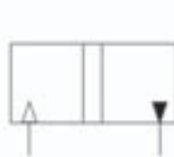
Echangeur de pression air-huile à simple effet
