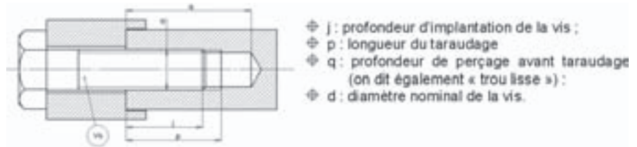
Figure 17.19 – Implantation d'une vis.
