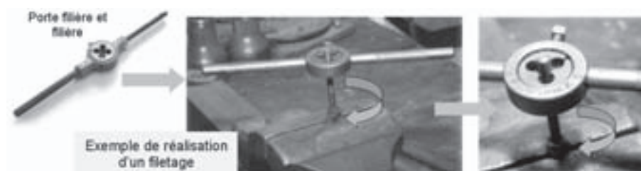
Figure 17.4 – Réalisation d'un filetage.
