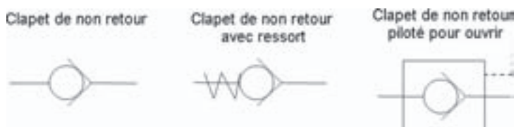
Figure 19.83b – Schématisation pneumatique et hydraulique NF ISO 1219.
