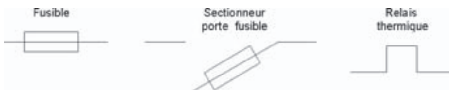
Figure 19.82b – Schématisation électrique CEI 61082.
