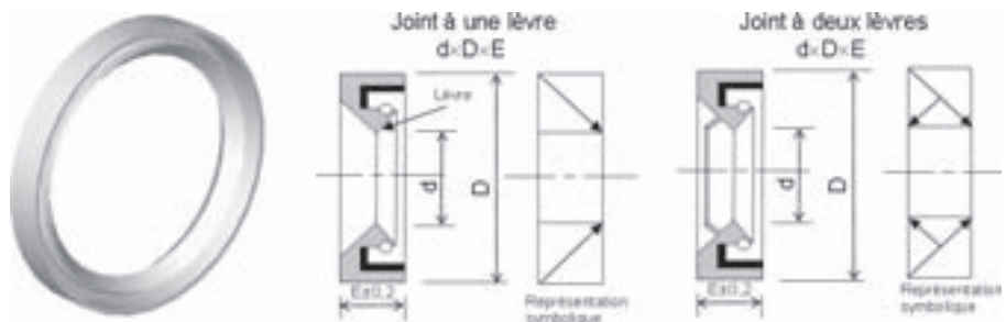
Figure 18.7 – Joints à lèvres à contact radial.
