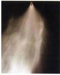
Simulation d'une application herbicide sans adjuvant. Vent latéral 7.5 km/h
