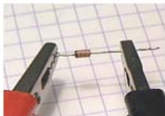
Fil rouge coté baguette et fil noir à l'autre patte: le courant passe
