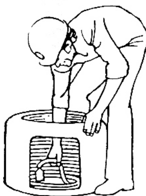
Figure 1 – Méthode pour enlever un câble de son contenant
