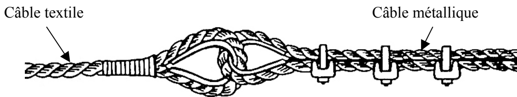
Figure 5 – Lorsqu'on relie un câble métallique à un câble textile, il faut placer une cosse dans chaque boucle
