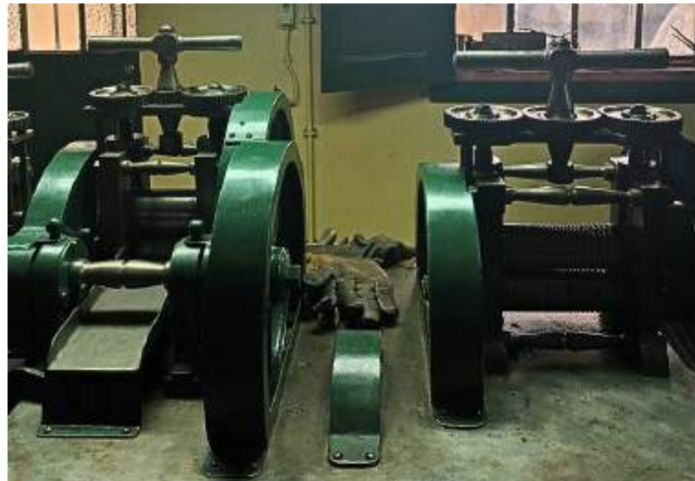
Outils traditionnels : tréfileuse (à droite) et plastifieuse (à gauche).
