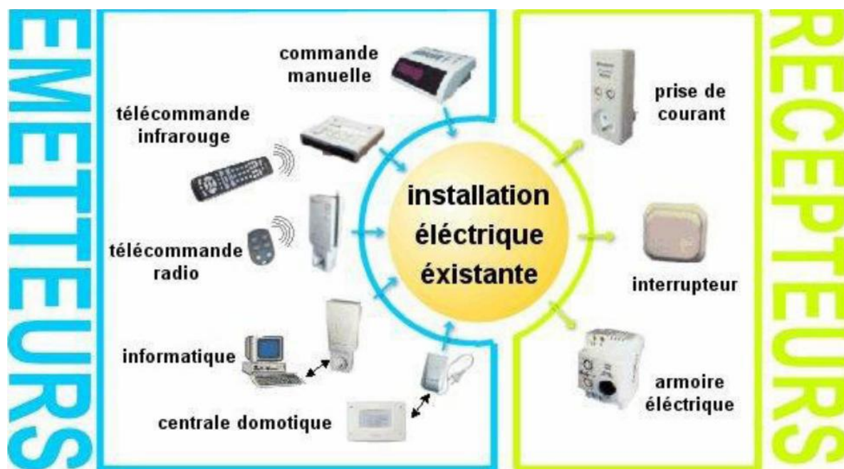
Figure I.14 Présentation de la technologie du courant porteur en ligne.
