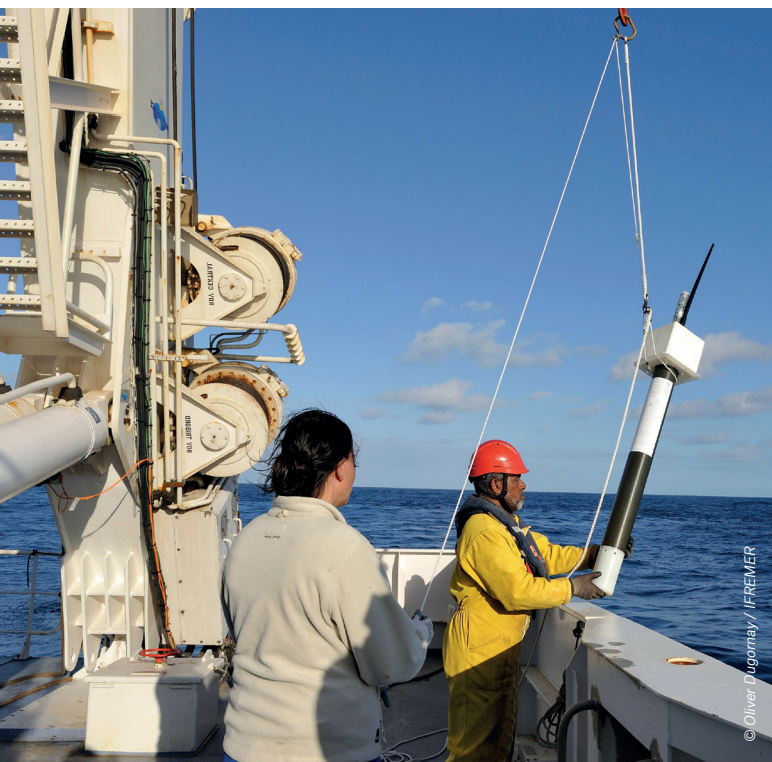
Le profileur Argo Arvor est un instrument sous-marin de mesure de la température et de la salinité au cœur des océans.
