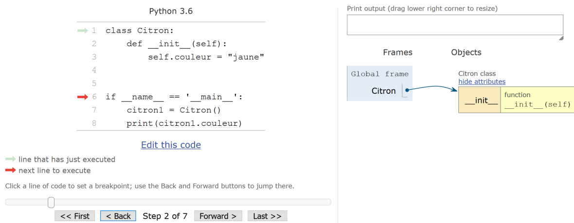
FIGURE 23.1 – Fonctionnement d'un constructeur (étape 1).
