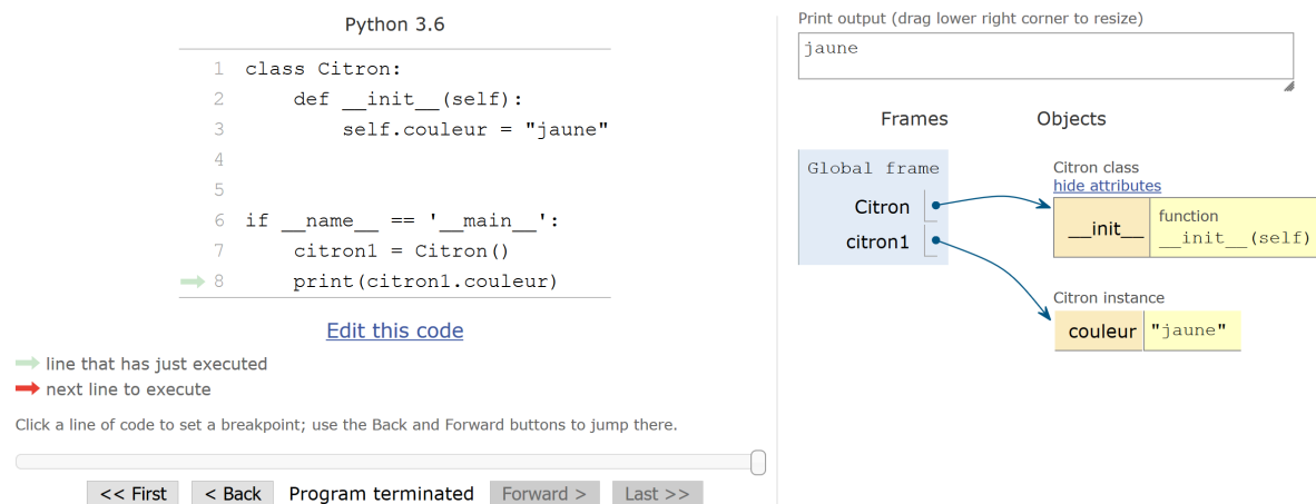
FIGURE 23.4 – Fonctionnement d'un constructeur (étape 4).
