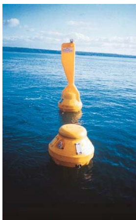
Bouée Marisonde : mesure la pression, le vent, la température et se positionne par système ARGOS
