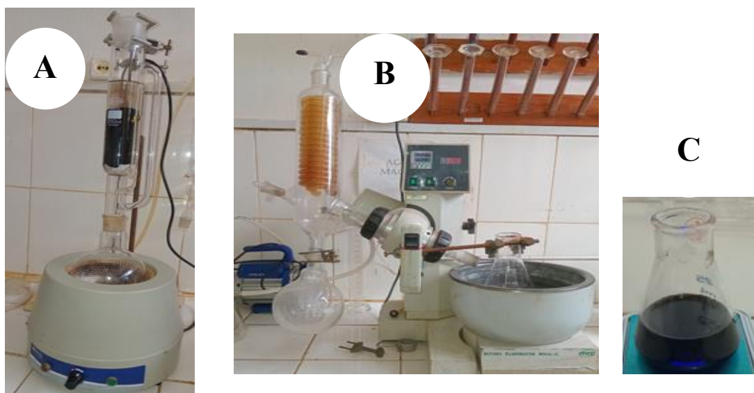
Photo 1 : Extraction de l'huile du marc de café par Soxhlet (A: Appareil de Soxhlet, B: Rotavapor, C: Huile grasse récupérée)
